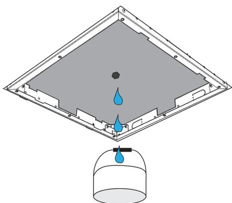
**ITA** - Assicurarsi di svuotare e pulire l'impianto idrico prima di collegare il corpo soffione.
