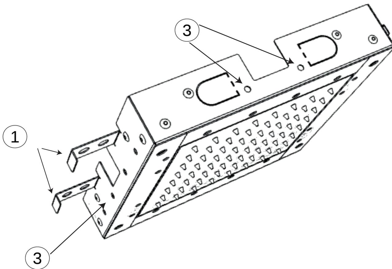
**ITA** - Per una corretta installazione del soffione multifunzione è necessario fissare saldamente il telaio di sostegno alla struttura del soffitto (od eventualmente al telaio del controsoffitto) per mezzo delle alette di fissaggio (1) o con viti autofilettanti passanti nei fori (3).
