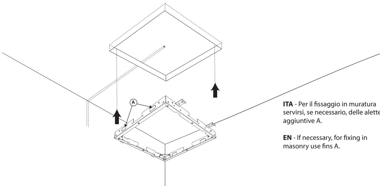
**ITA** - Per il fissaggio in muratura servirsi, se necessario, delle alette aggiuntive A.
