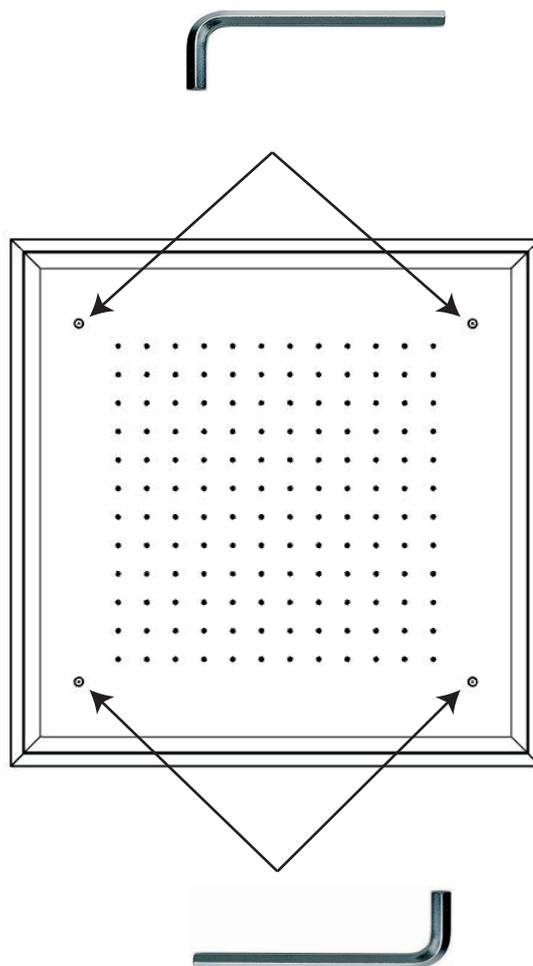
**ITA - Fig.1** Il vostro nuovo soffione viene fornito assemblato nell'imballo. Facendo attenzione a non rimuovere la pellicola protettiva ed utilizzando i guanti in dotazione (ogni volta che si manovra la parte estetica), utilizzando la chiave a brugola, anch'essa in dotazione, svitare le quattro viti segnalate in Fig.1: a questo punto la parte estetica/meccanica con gli accessori si sarà liberata dal telaio. Momentaneamente accantonare la parte.
